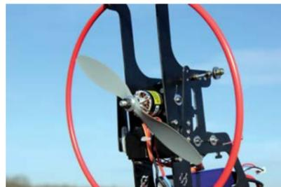
Les fils des équipements devront être immobilisés proprement afin de ne pas rentrer en contact avec l'hélice.
