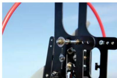
Des vis M4 de 40 mm permettent d'arrimer la voile au châssis. Elles peuvent être fixées à trois emplacements différents, suivant le centrage de la nacelle.
