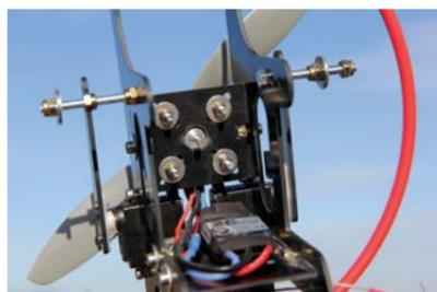
Les platines en carbone s'assemblent grâce à des écrous M3. Le moteur se fixe par l'arrière directement sur la platine.
